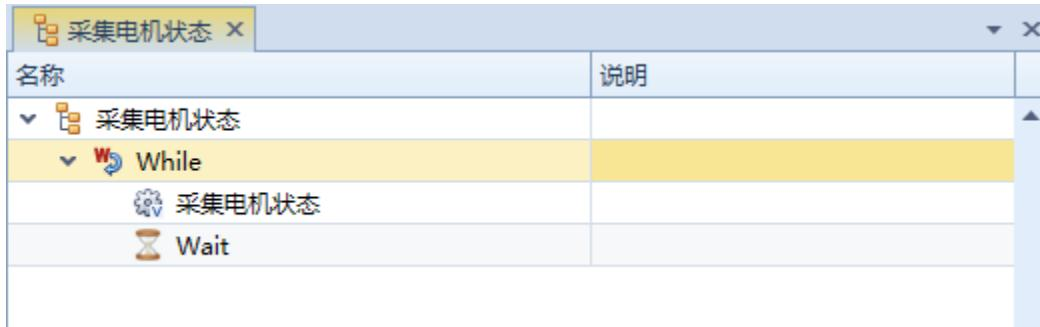
采集电机状态步骤的脚本如下，调用动态库 MotionManager. **GetStatus** 接口函数进行状态采集，采集后的数据保存到变量中，自动进行数据存储和用户界面显示。
