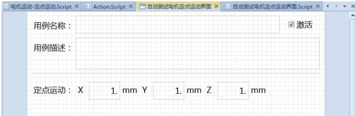
“自动测试电机定点运动界面”的脚本主要功能是将测试用例的参数和界面控件绑定，以便控件的数值修改时自动修改测试用例参数的值。
