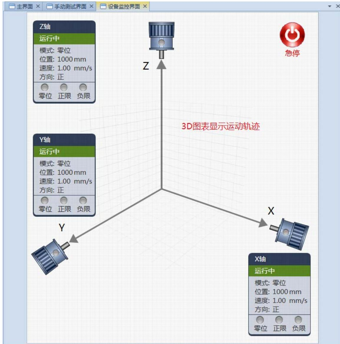
数据绑定的操作方法比较简单，例如本例子 X 轴电机上的指示灯，需要绑定到变量“电机变量/X 轴状态/Run”，先选中指示灯控件，然后在属性面板双击“State”属性，弹出数据绑定对话框，选择绑定类型为“表达式”（因为变量 Run 的值 0 表示停止，1 表示运行，而指示灯绿灯是 1，红灯是 3，故需要用表达式 IF 进行转换，表达式为 IF(Value[0]=1, 1, 3)，即变量值等于 1 时返回 1，否则返回 3。），在对话框的变量列表中添加变量“电机变量/X 轴状态/Run”，最后在表达式文本框中填入表达式即可。
